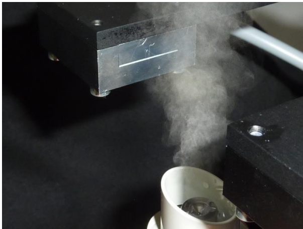
Kontrola rozpylanej cieczy inhalatora w strefie zagrożonej wybuchem za pomocą światłowodowego konwertera przekroju poprzecznego.
